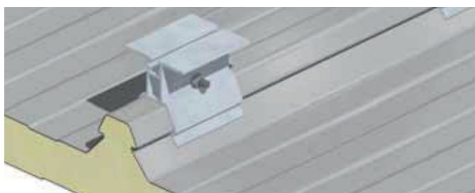
Detalle enganche de accesorios para cubiertas
