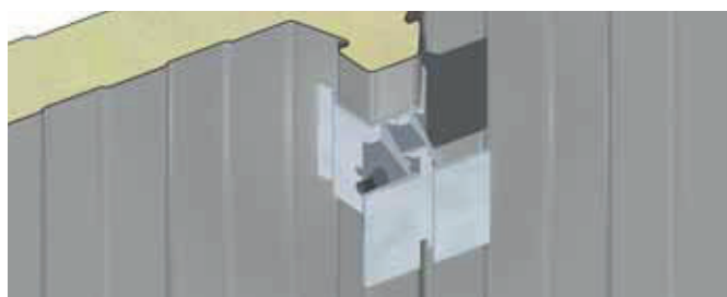
Detalle enganche de accesorios para fachada
